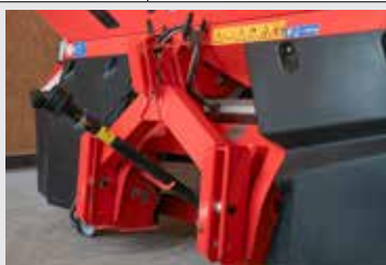
Järeldaigaldatav kaaluseade väetisekastis oleva jäägi tuvastamiseks
