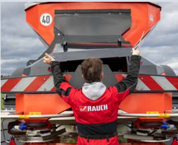
Masina mugavaks puhastamiseks saab laotusseadme katet eemaldada
