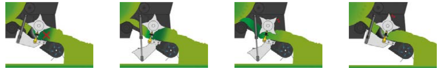
Ummistuse korral langetatakse löikepõranda tagumist osa 500 mm võrra.
