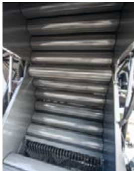
Kolm PowerGrip terasrulliku ribi on alati rulliga kokkupuutes ja tagavad usaldusväärse pööramise.
