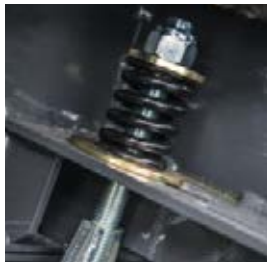
Flexcontrol-vedru leevendab löikepõranda esiosa koormusmaksimume, hoides ära ummistusi.
