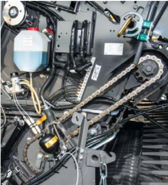
■ Suurest paagist jaotatakse õli harjadele või kettide puhastussvammidele, mis selle ühtlaselt kettidele kannavad.
