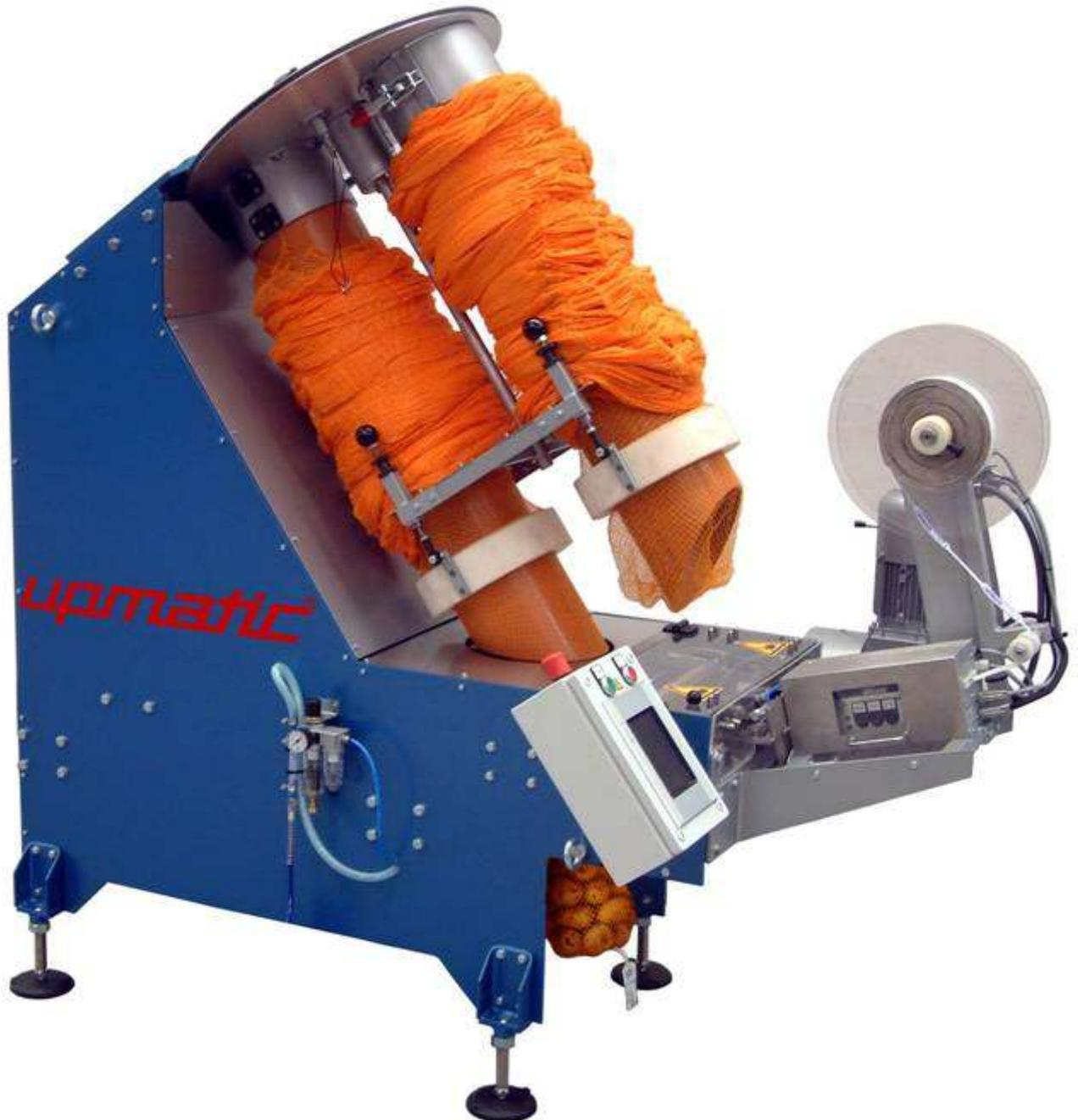
**Upmatic Typ 3006 = vollautomatischer Doppelrohr-Netzclipper für Füllgewichte von 0,5 bis 5 kg. Geeignet für alle klein- und grobstückigen Produkte des Lebensmittel und des Non-Food-Bereichs.**
