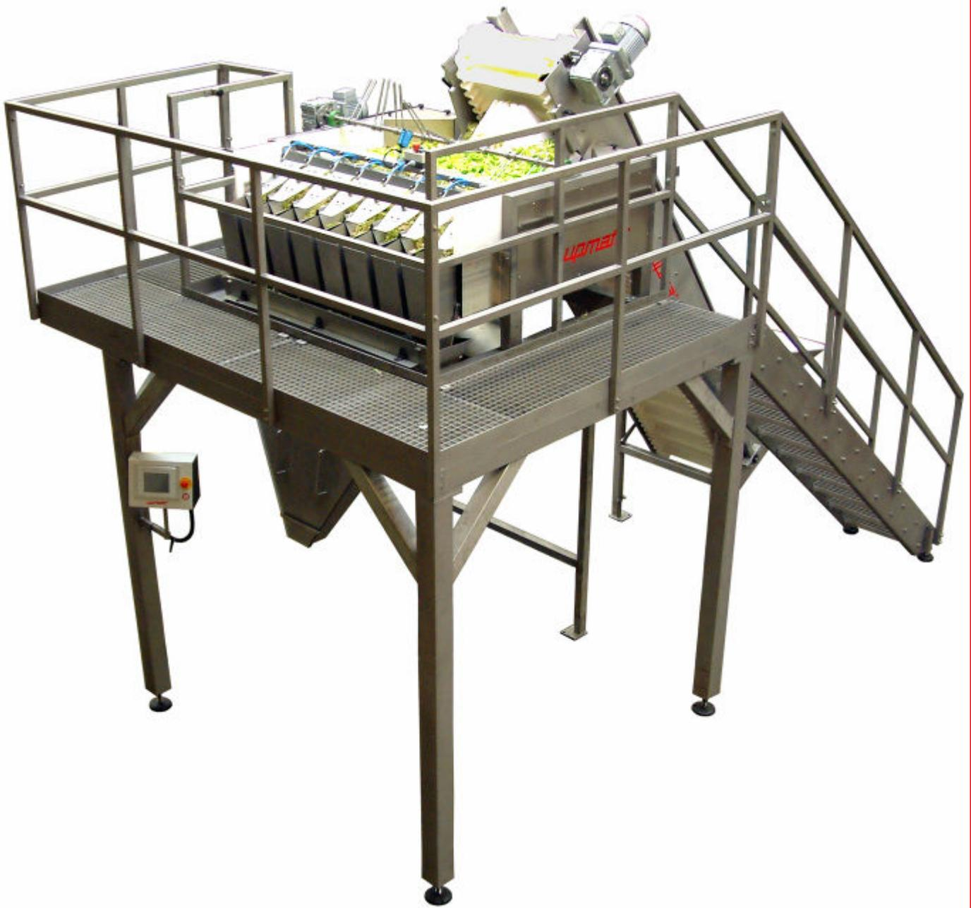
**Upmatic Typ 2208 = computergesteuerte Teilmengen-Wiegemaschine für klein- und grobstückige Güter des Lebensmittel- und des Non-Food-Bereichs. Der Wiegebereich umfasst, abhängig vom Produkt, alle Gewichtsklassen von 100g bis 2500g (höhere Gewichte durch Mehrfachschüttung)
