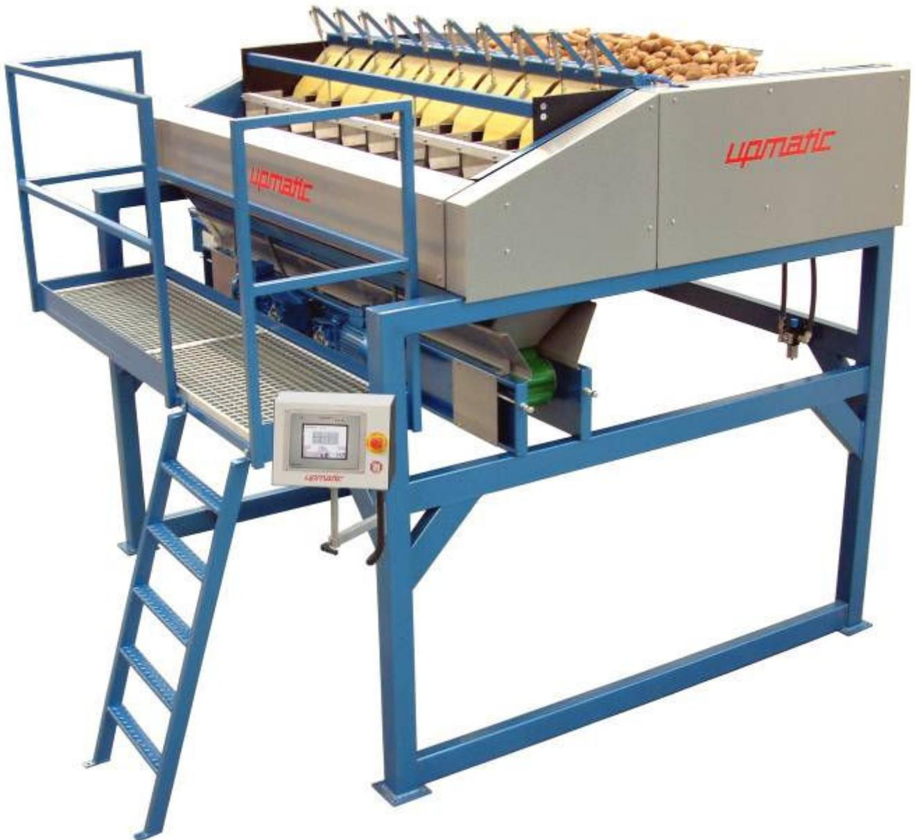
**Upmatic Typ 2110 = computergesteuerte Teilmengen-Wiegemaschine für klein- und grobstückige Güter des Lebensmittel- und des Non-Food-Bereichs. Der Wiegebereich umfasst alle Gewichtsklassen von 0,5 kg bis 25 kg - Wiegen ohne Verluste.**
