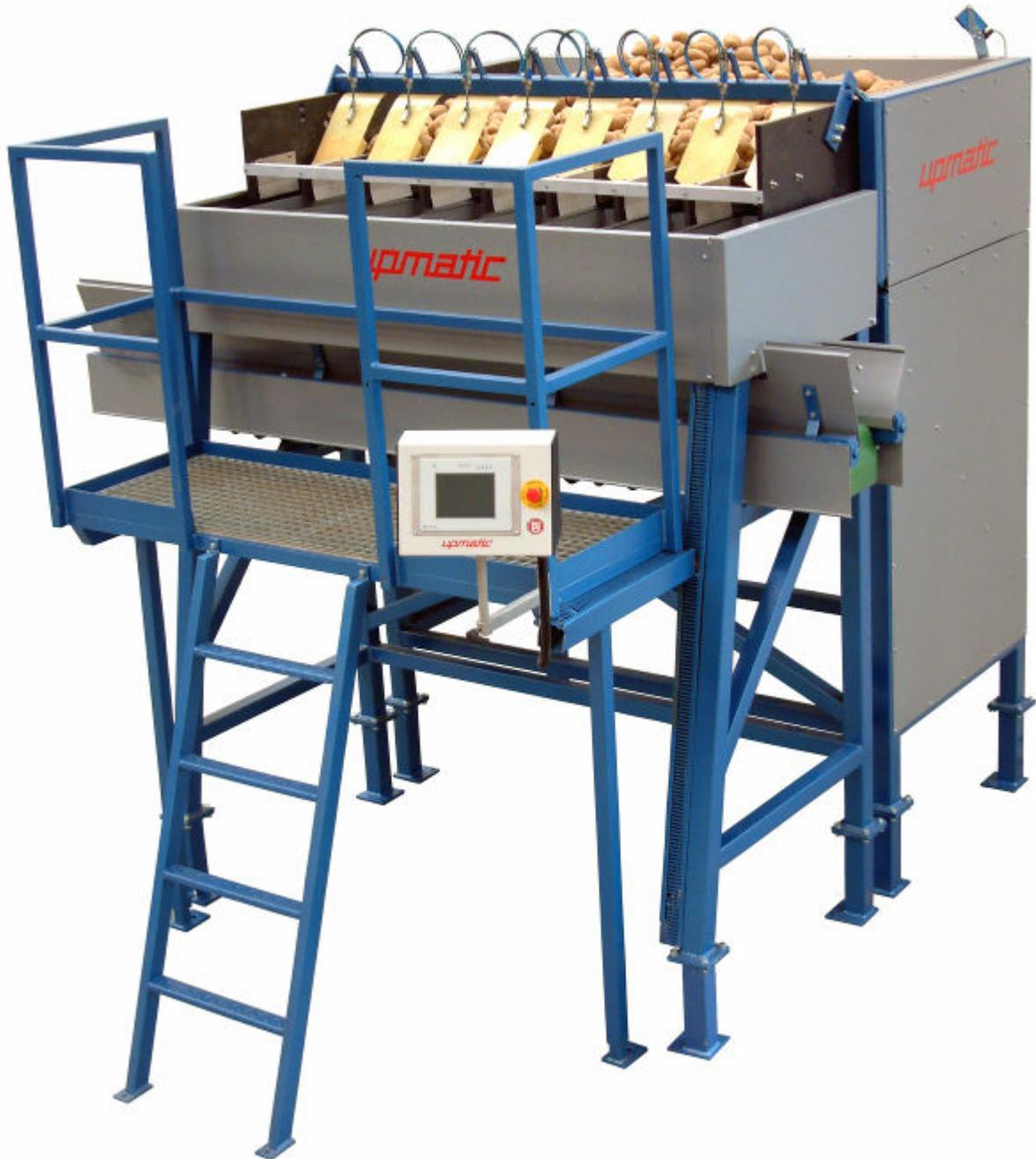
**Upmatic Typ 2008 = computergesteuerte Teilmengen-Wiegemaschine für klein- und grobstückige Güter des Lebensmittel- und des Non-Food-Bereichs. Der Wiegebereich umfasst alle Gewichtsklassen von 0,5 bis 25kg - Wiegen ohne Verluste.**
