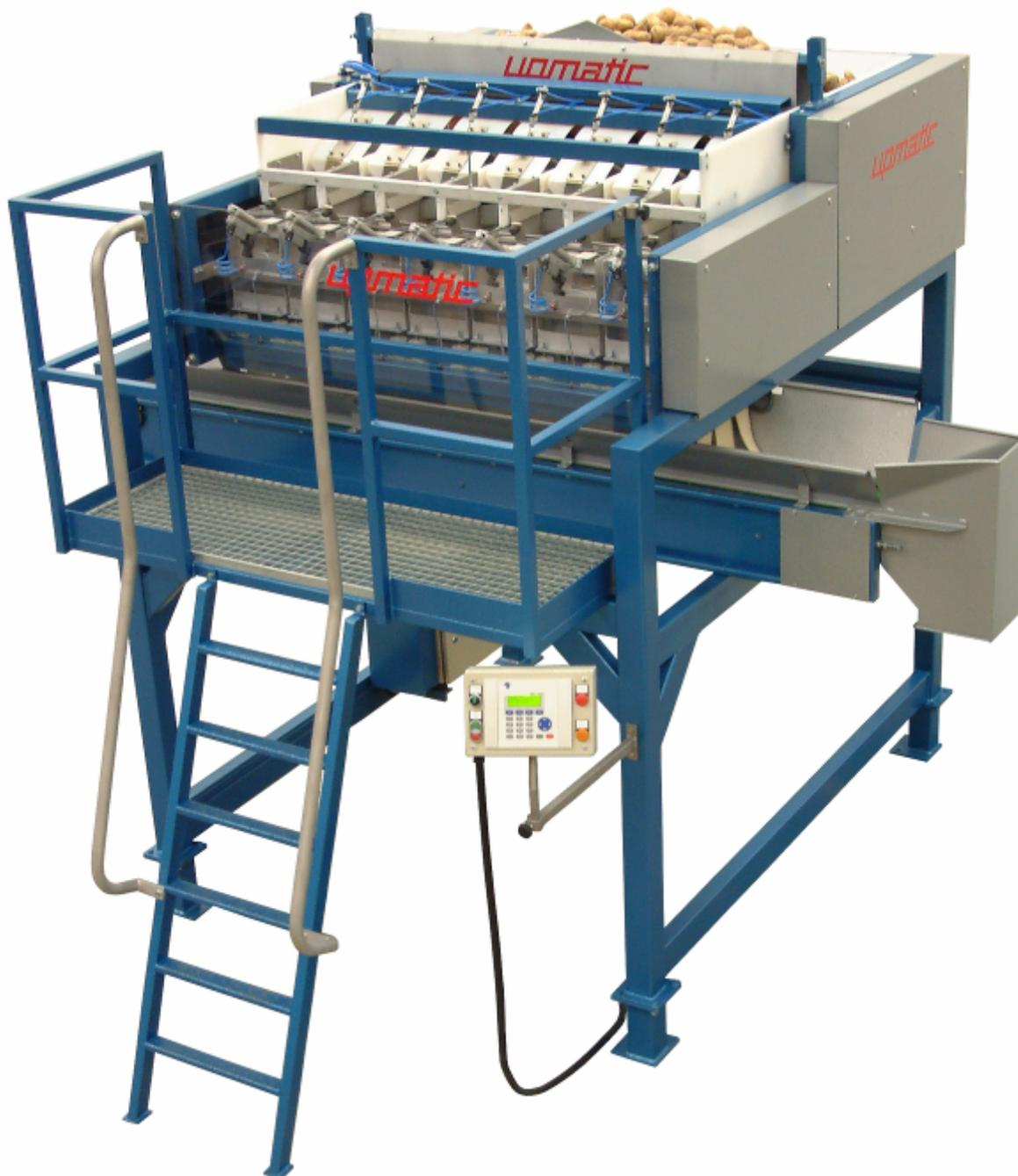
**Upmatic Typ 2007 = computergesteuerte Teilmengen-Wiegemaschine für klein- und grobstückige Güter des Lebensmittel- und des Non-food-Bereichs. Der Wiegebereich umfaßt alle Gewichtsklassen von 1 bis 25kg - Wiegen ohne Verluste.**
