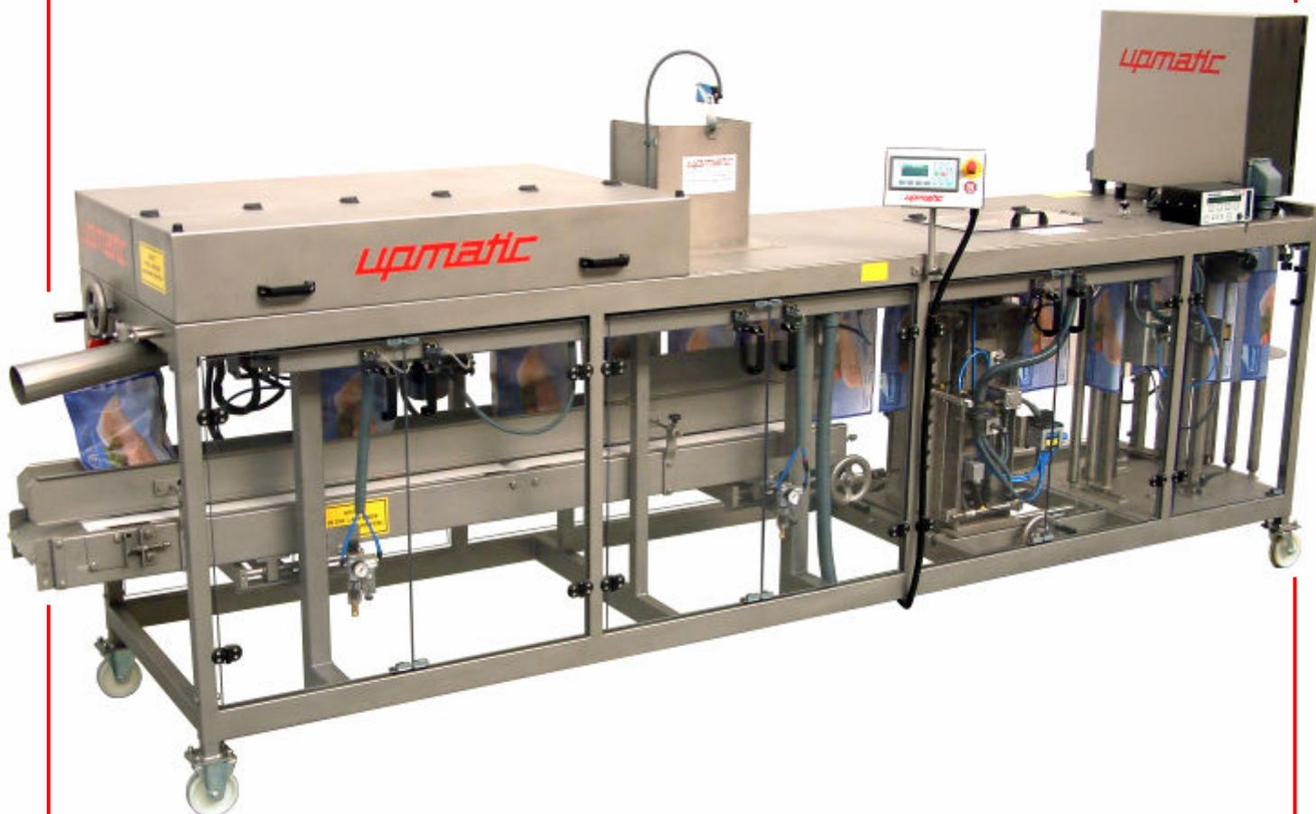
**Upmatic 2000IET = vollautomatische Füll- und Verschleißmaschine für Polyäthylenbeutel von 0,5 bis 10 kg Füllgewicht. Für alle stückigen und körnigen Produkte des Lebensmittel- und des Non-food-Bereichs geeignet.**
