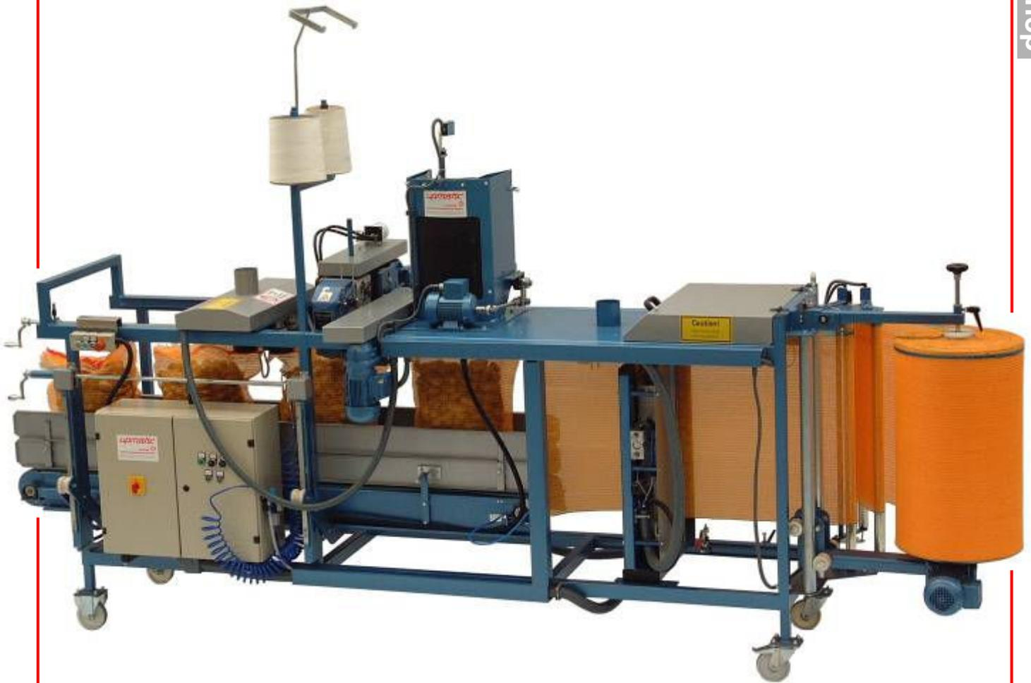
**Upmatic 1351 = vollautomatische Füll- und Verschlussmaschine für Raschelsäcke von 2,5 bis 50 kg Füllgewicht. Je nach Wahl des Verpackungsmaterials für alle stückigen und körnigen Produkte des Lebensmittel- und des Non-food-Bereichs geeignet.**
